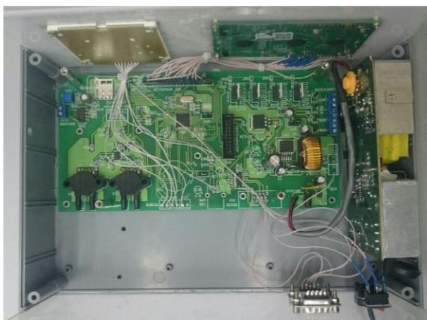
Рисунок 1 – Размещение электронных блоков в корпусе прибора.
