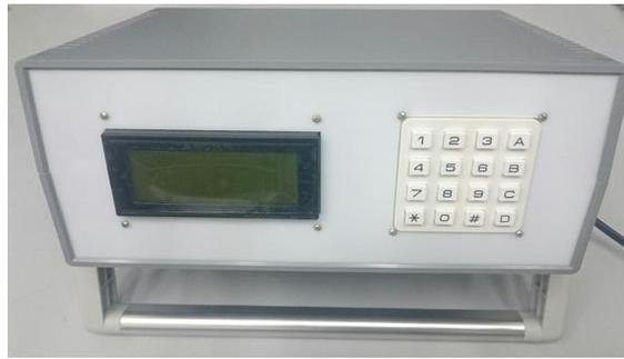
Рисунок 3 – Внешний вид гидроманжетного прибора для оценки гемодинамических параметров.
