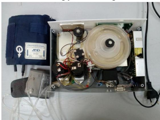
Рисунок 2 – Конструкция гидроманжетного блока.
