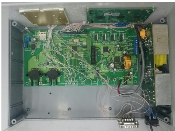
Рисунок 1 – Размещение электронных блоков в корпусе прибора.
