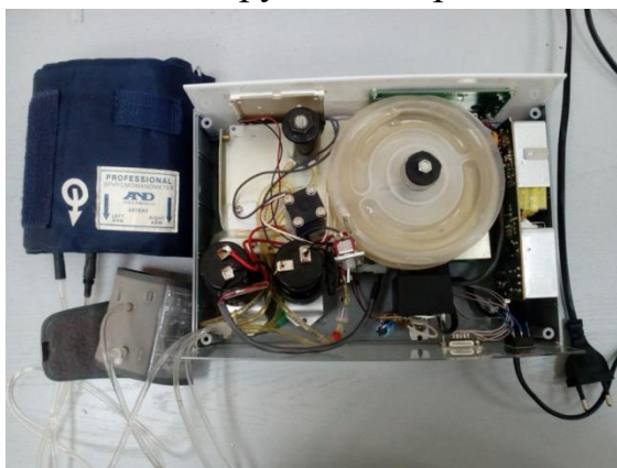
Рисунок 2 – Конструкция гидроманжетного блока.
